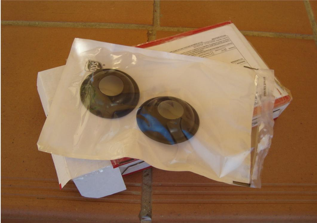
En una caja, un sobre con las dos membranas, así que me puse al lío. Lo primero de todo fue desmontar las tapas de los carburadores, estas dos tapas suelen venir con tornillos de estrella, pero los míos estaban muy pasados y los cambié por tornillos de cabeza hexagonal,
