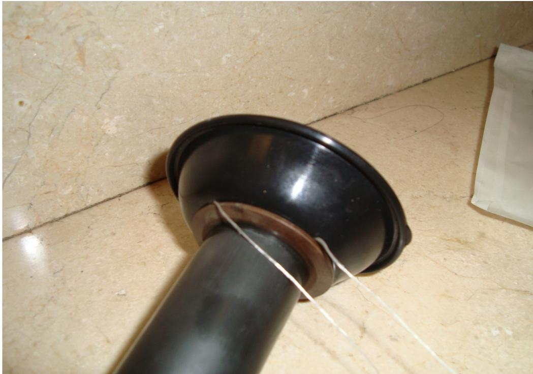
Y después, doblamos la membrana hacia atrás y le damos otra vuelta con el hilo para asegurarnos de que está bien del todo.
