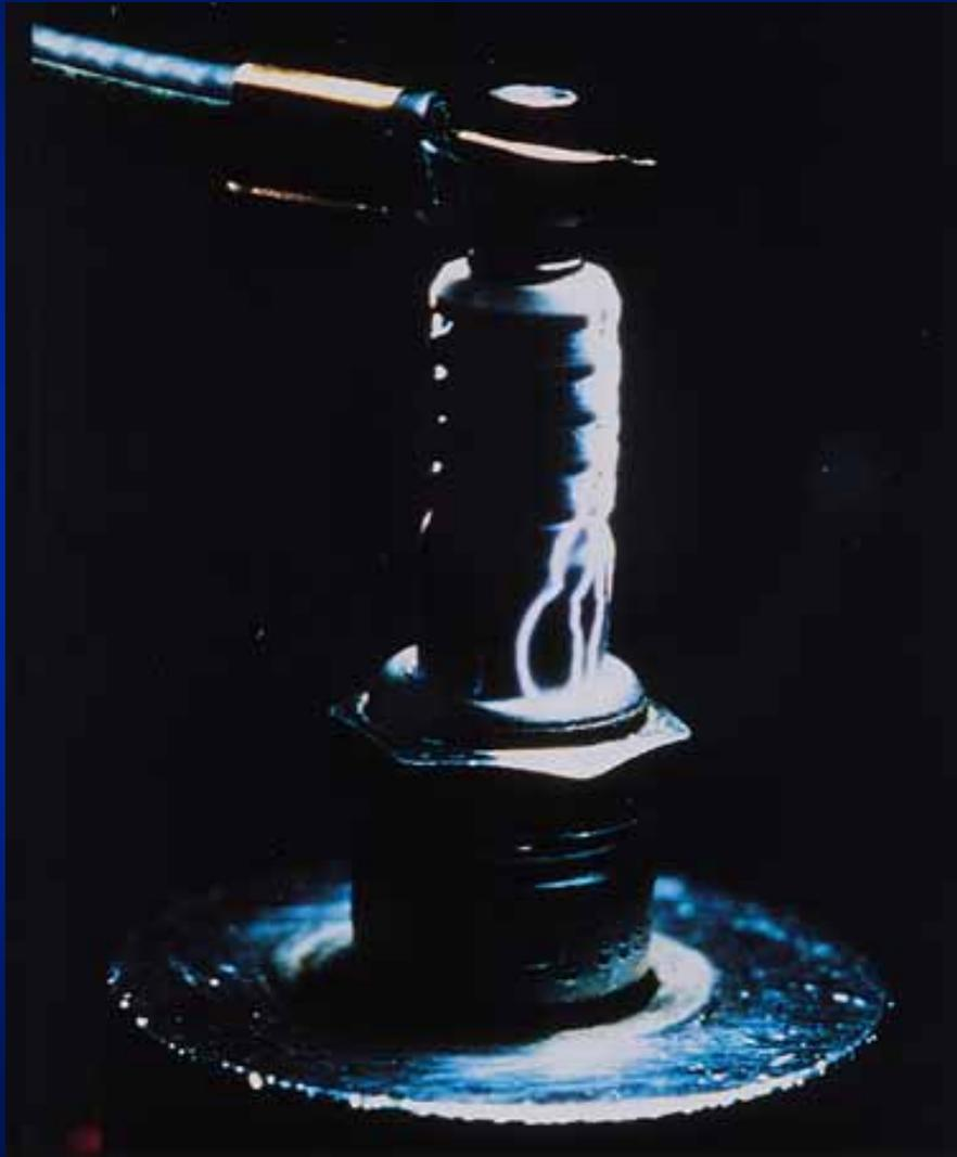
Para evitar que el alto voltaje tienda a fugarse a lo largo de la superficie del aislador, se incorporan ranuras como parte de este. Dichas ranuras extienden la distancia asegurando el aislamiento.
