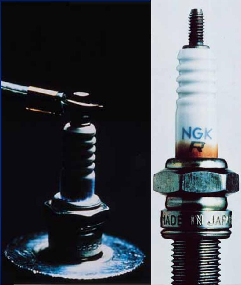
Es el resultado de partículas de aceite en suspensión que se adhieren a la superficie del aislador por efecto del alto voltaje.
